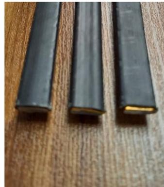
**Цель** - разработка и организация производства специализированного греющего кабеля для прогрева нефтяных скважин
