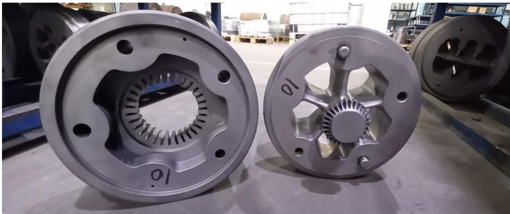
**Цель** - разработка и организация серийного производства алюминиевого теплообменника для охлаждения электродвигателей, которые используются в нефтяных скважинах
